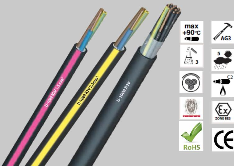
NF C 32-321 ou XP C 32-321(\*\*\*) : câbles rigides isolés au polyéthylène réticulé sous gaine de protection en polychlorure de vinyle – série U-1000 R2V.
